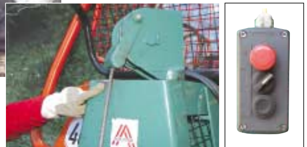
Beim Zuzug über die untere Umlenkrolle kommt es zu Scheuerungen am Wickelturm. Die Bedienflasche ist bei kalter Witterung bruchanfällig.
